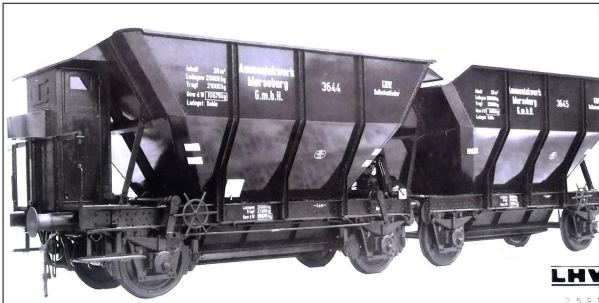
Bild 2 Doppel-Talbot-Wagen der Firma Talbot Aachen (Selbstentlader, Kennzeichnung: Ammoniakwerk Merseburg G.m.b.H., um 1937)
