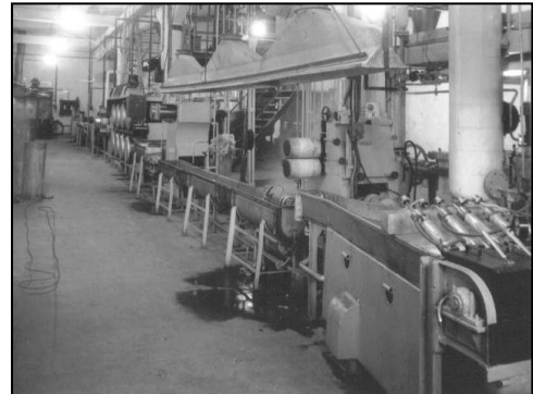
Bild 43 Halbtechnische Versuchsanlage zur Herstellung von PAN-Fasern in der Filmfabrik Wolfen (1952)
