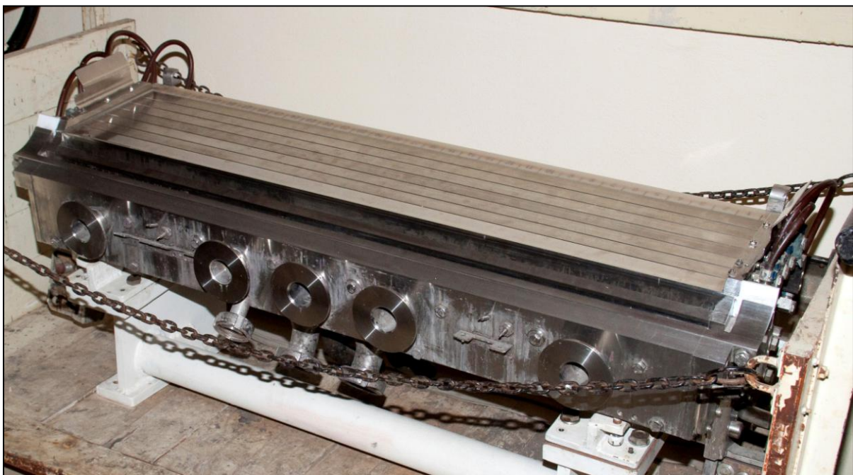
Bild 8 6-Schlitzkaskadengießere VSG 6-1200 H
