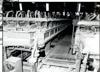
Bilder 1a+b Blick in den Elektrolysesaal der Chloralkalielektrolyse im Buna-Werk Schkopau (a: großes Bild oben, b_kleines Bild unten rechts: Detailansicht Chlorzelle)
