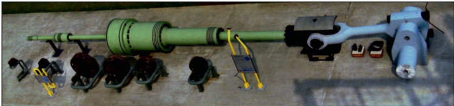
Bilder 7a+b Fünfstufiger Zschimmerverdichter (a_Laufzeug des Verdichters im Technik- park des DChM, Bild oben, 2000er Jahre, b_historisches Foto eines kompletten Aggregates, Bild rechts, Leuna-Werke , vor 1991)
